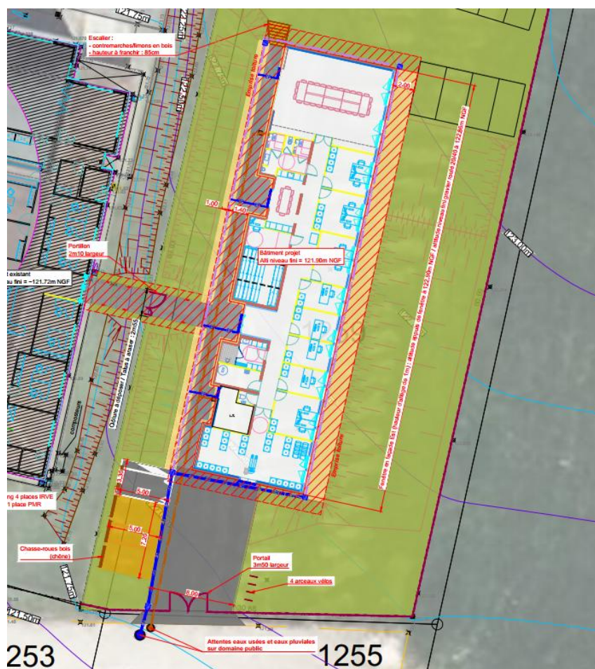
Figure 13 - Plan de masse réseaux humides
