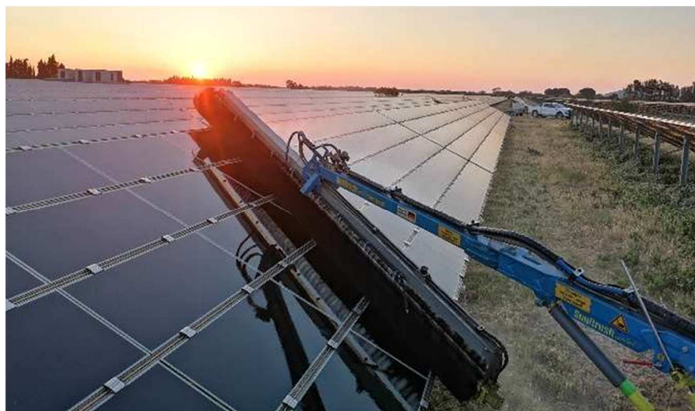
Exemples de procédé de nettoyage des modules
