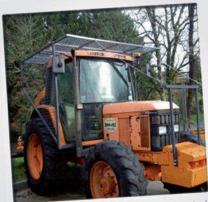
Tracteur du Centre technique de Brantôme, équipé de grilles de protection contre les branches lors de l'élagage des routes. Ce type de dispositif a été fabriqué et monté par les deux mécaniciens de la communauté de communes.
